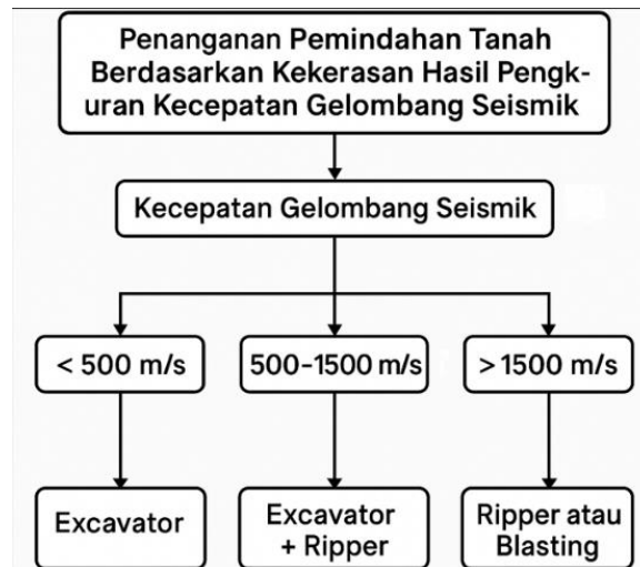
Gambar 2-2 Penanganan Pemindahan Tanah Berdasarkan Kecepatan Gelombang Seismik
